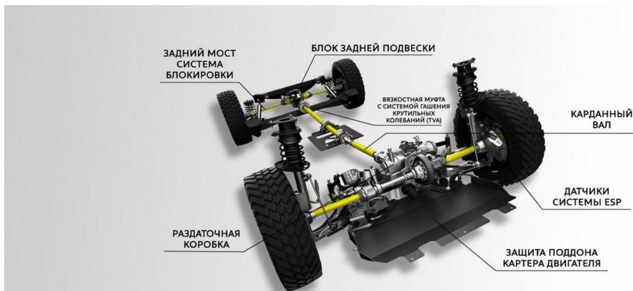
Версии 4x4 оснащаются трансмиссией с вискомуфтой, способной передавать до 100% крутящего момента на заднюю ось. Работая синхронно с системами стабилизации ESC и ASR система полного привода постоянно «следит» за возможным проскальзыванием колес и мгновенно распределяет мощность именно на то колесо, которое имеет максимальное сцепление с дорожной поверхностью.
